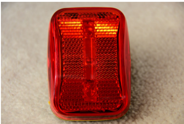
▲汽車後的反光片或煞車燈，其反光原理跟小羽枝的奈米結構一樣，只是沒那麼精緻
